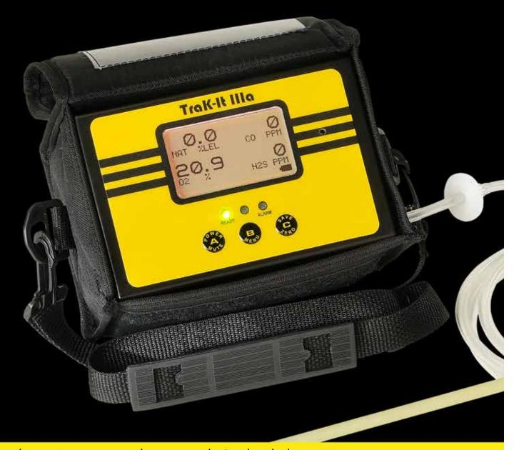
Muestra hasta 4 gases | Bomba interna de 2 velocidades | Diseño intrínsecamente seguro
