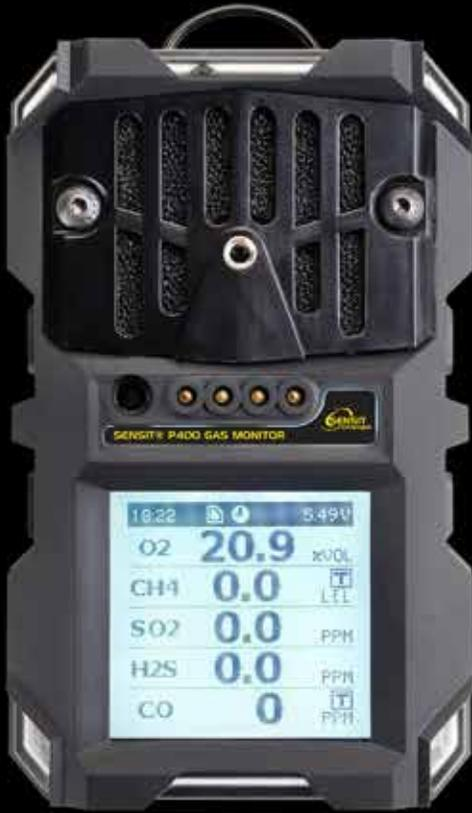
Muestra hasta 5 gases simultáneamente
